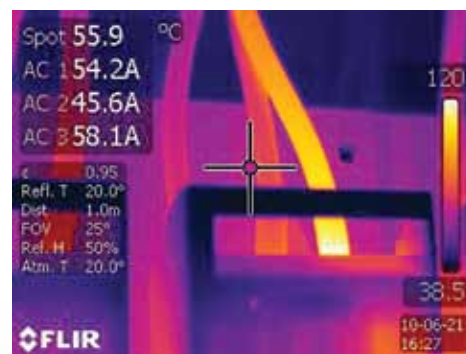
Проверка электрической проводки рядом с предохранителями, покрытыми оргстеклом, выявляет наличие отклонений от нормы. MeterLink позволяет вывести показания, полученные при помощи токоизмерительных клещей, на тепловизионном изображении.
