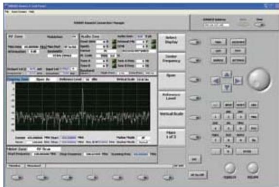
Виртуальная клавиатура прибора на стандартном ПК, оборудованном Программным обеспечением 2830, включает каждую клавишу панели управления Multilock. Нужно только назначить прибору IP-адрес - и всеми функциями прибора можно управлять с удаленного ПК; Вы можете, например, контролировать работу любого канала, измерять уровни помех или мониторить работу всего объекта.
