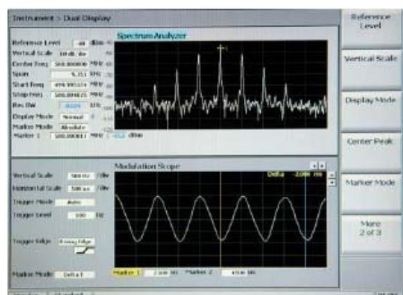
2801 Multilock представляет новую функцию DualScope, которая позволяет отображать спектр радиочастот и область модуляции одновременно, давая пользователю возможность проанализировать характеристики несущего сигнала и демодулированного аудиосигнала на том же самом экране. В режиме DualScope реализуются полные функциональные возможности двух разных приборов, и отображаются одновременно все связанные измерения. Режим DualScope включен в опцию / 2862 - Опция Улучшенного Анализатора спектра /
