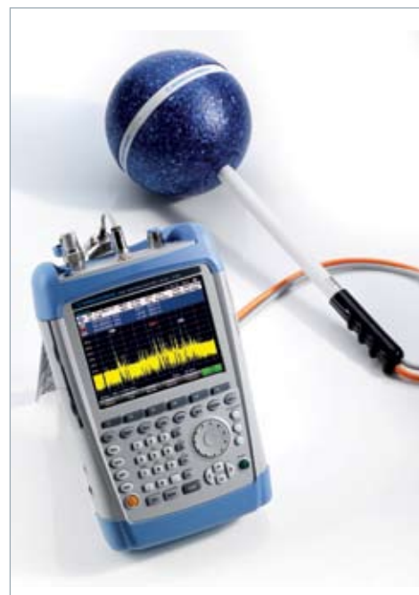
R&S®FSH с всенаправленной антенной R&S®TS-EMF
