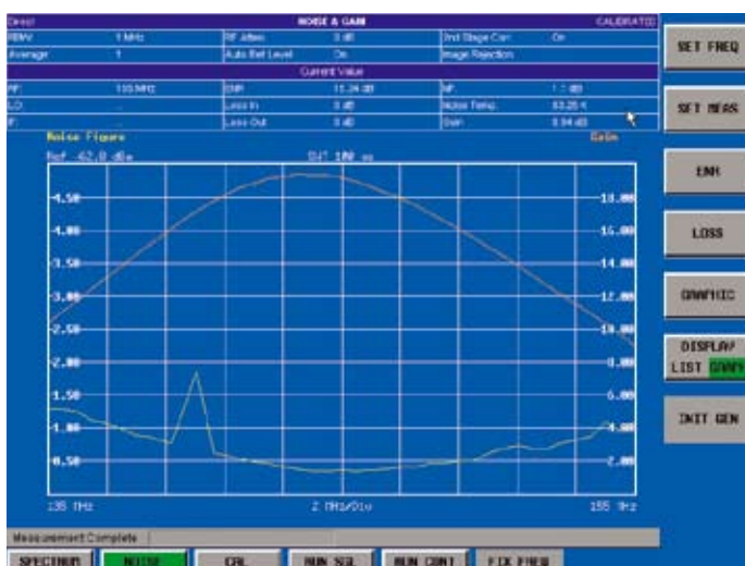
Измерение коэффициента шума с помощью опции R&S®FS-K30
