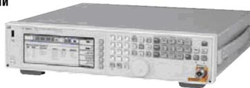
На выход поступает сигнал в диапазоне от 80 до 1000 МГц, модулированный прямоугольным сигналом (от внешнего источника). Глубина модуляции устанавливается до величины 90%. Выходной уровень генератора задается программой, что позволяет компенсировать амплитудные характеристики усилителя мощности MAP202 и широкополосной антенны MAN101 для обеспечения заданной напряженности электрического поля от 1 до 10 В/м.
