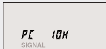
Рис.4. Обнаружен сигнал 10 Base-T, подключение к компьютеру
